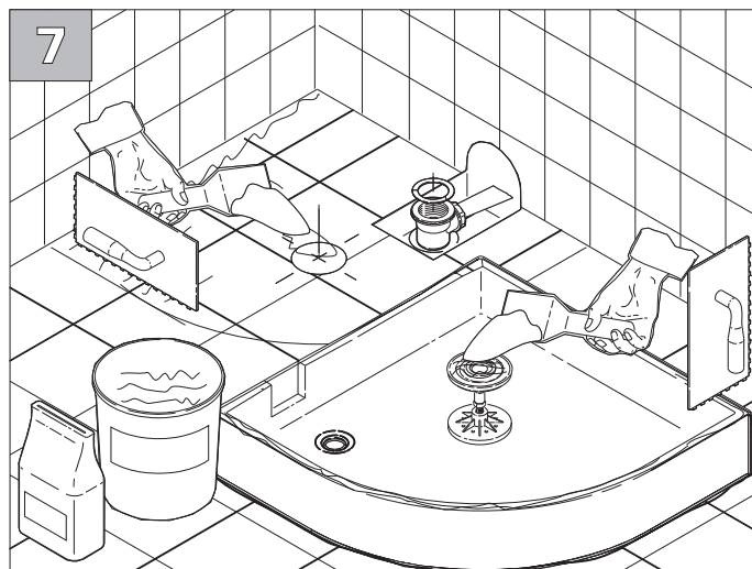
7 W miejscu ustawienie stopy brodzika nałożyć zaprawę klejową
